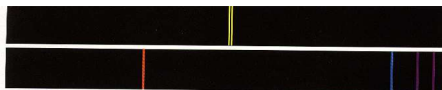
Fig. 9. Espectros de emisión del sodio (superior) y del hidrógeno (inferior).
